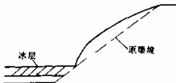
图 2-11 渠道冰面以上渠堤较高时冰面处的冻胀受冰层限制的冻胀变形示意图
