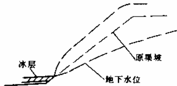
图 2-12 地下水位接近坡顶时渠坡冻胀变形示意图
