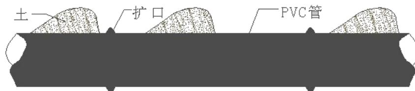
图 4.12 管道覆土固定示意图
