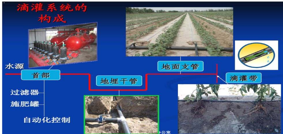
图 2.1 (c) 膜下滴灌系统实物图
