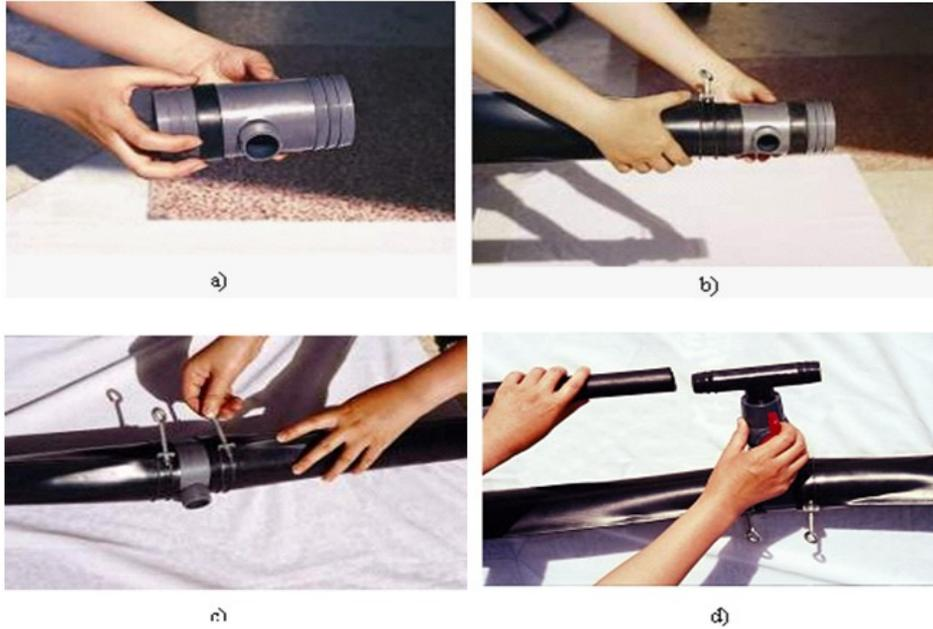
a) 安装胶圈 b) 承插三通插入支管 c) 承插三通与支管连接 d) 支管、辅管连接
