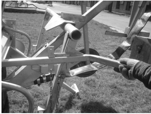
图 4-3 调整喷水行车轮距
