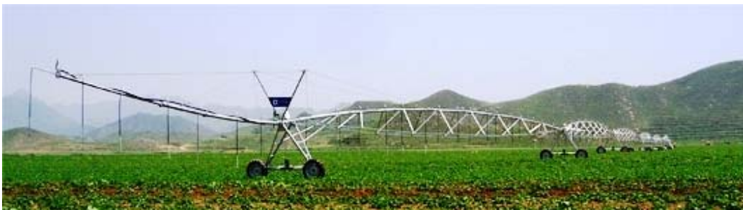
图 2.1 典型配置中心支轴式喷灌机
