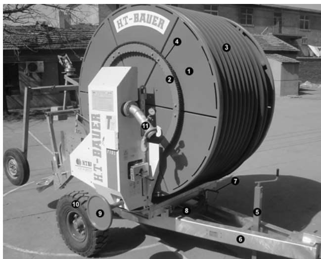
1 绞盘、2 链板、3 PE 管、4 绞盘驱动链条、5 千斤顶、6 底盘、 7 回转支撑定位销、8 回转支撑、9 手轮、10 轮胎半轴、11 进水管
