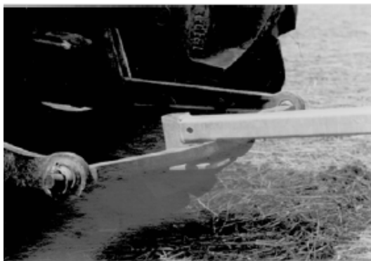
图 4-6 设定扇形喷洒角度
