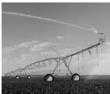
图 3 带末端喷枪的喷灌机
