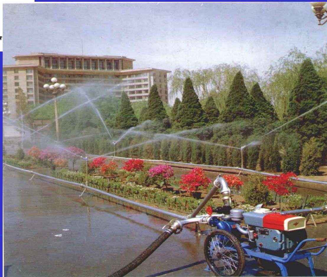
图 3-5 手扶拖拉机配套的悬挂式喷灌机 1—水源；2—吸水管；3—水泵；4—手扶拖拉机；5—皮带传动系统；6—输水管 7—竖管及支架；8—喷头
