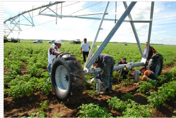
拖移型转移前需支起塔架车转换轮胎方向
