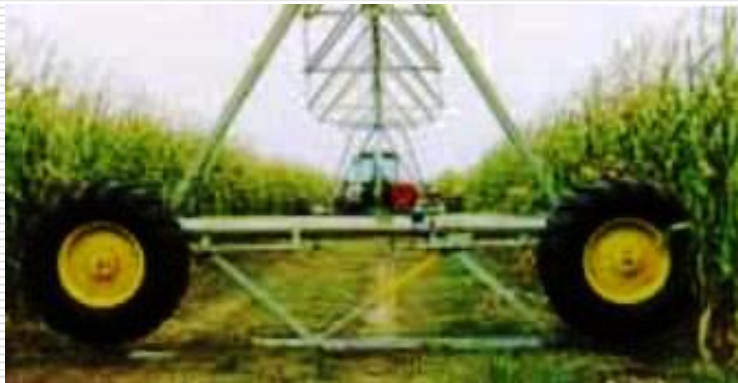
拖移型转移前需支起塔架车转换轮胎方向
