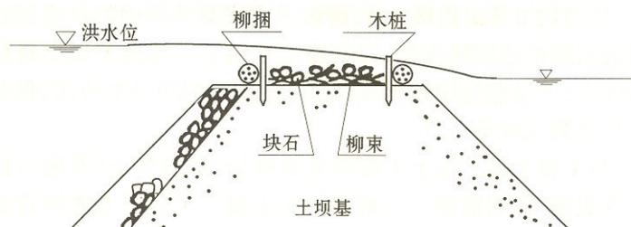
图 A.2-1 柳料护顶示意图
