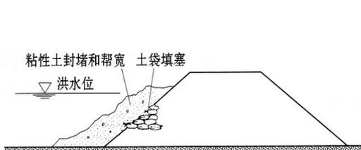
图 D.5-2 填塞封堵跌窝示意图
