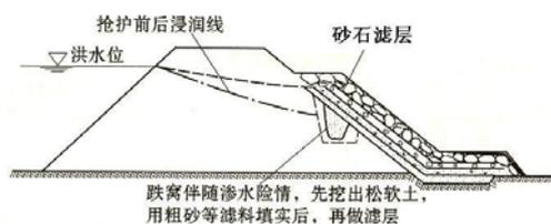
图 D.5-3 填筑滤料抢护跌窝示意图
