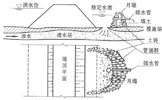
图 C.5-1 背水围堰（月坝）示意图
