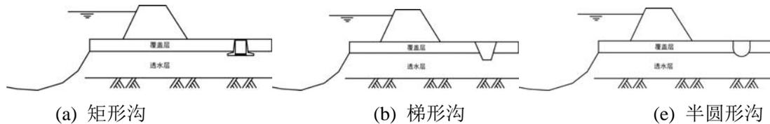
图 C.1-2 排水沟形状示意图
