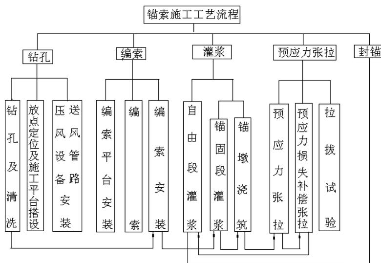
图 E.2-1 锚固施工工艺流程图
