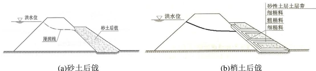
图 D.4-1 下游坡透水后戗
