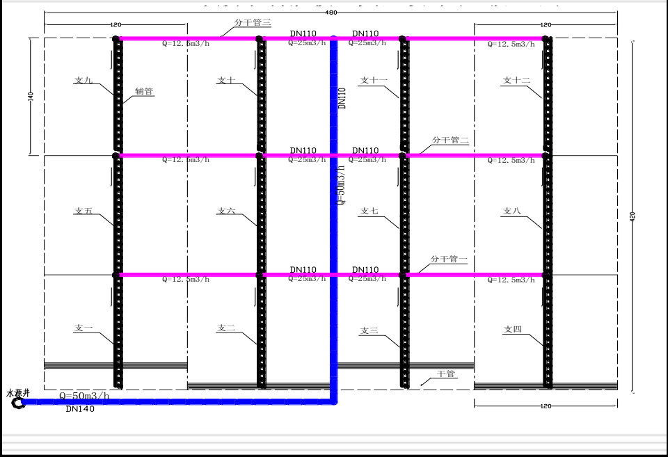
坡地玉米膜下滴灌典型设计（辅管轮灌）
