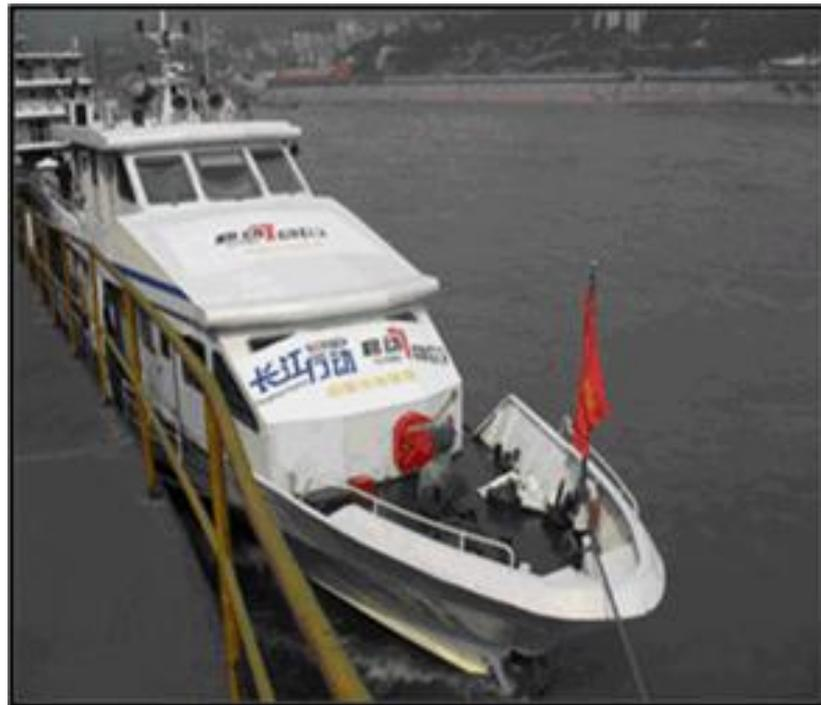
央视CCTV12频道于2007年“长江行动”启用的“长江水环监2000”水质监测船，是目前我国江河上最先进的水环境监测船。这艘监测船能够快速、准确地进行长江水环境监测，监督、监测沿江入河排污状况，并对省界水体、重点污染河段及水污染事故实行动态监测。
