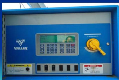
平移喷灌机主控制箱中的数值面板
