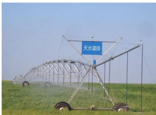
图 3-5 江苏天水灌排时针式喷灌机
