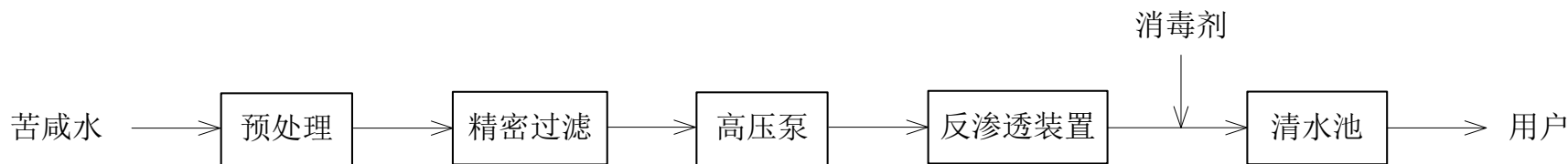
图4-17 反渗透法除氟工艺流程图
