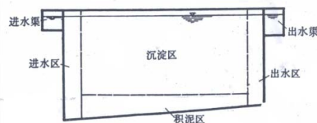
图 6-19 平流式沉淀池示意图
