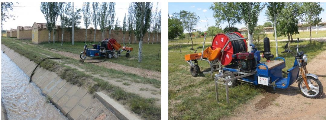
自驱动集成式一体化喷滴灌两用机
