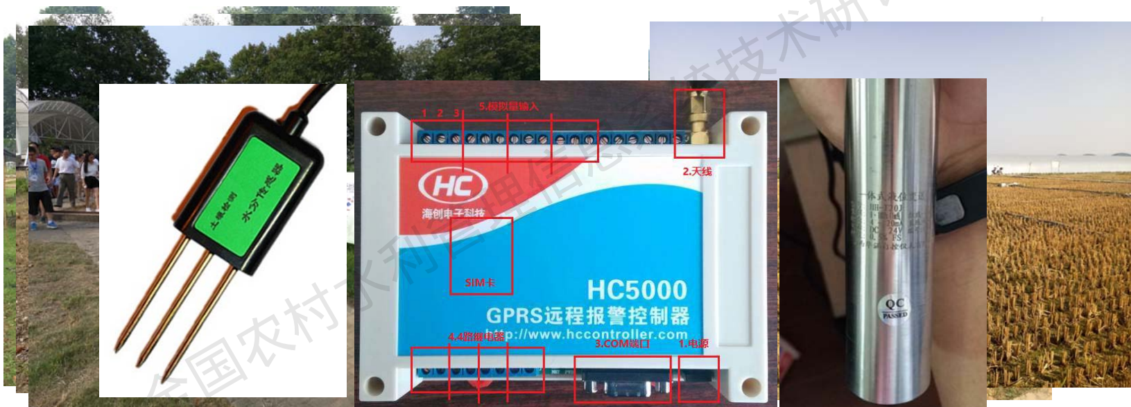
左：土壤水分传感器 中：控制器 右：水位传感器
