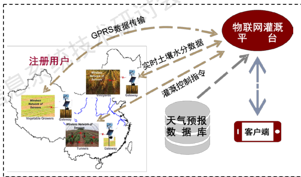
图1 管理平台架构示意图
