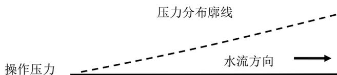
图 B.2.2-1 当  $I \leq C_1$  时沿毛管的压力水头分布示意图
