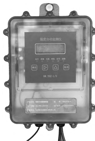
图5 一体式保温井房内的温度传感器
