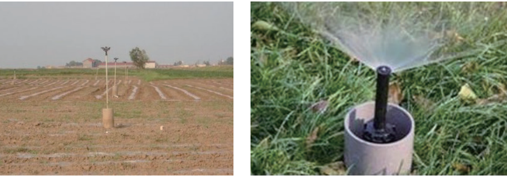
图2 传统的固定管道式喷灌及草坪喷灌的地上设备
