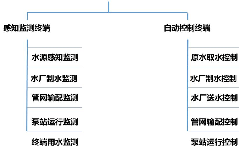
图 4.2 物联网感知监测终端
