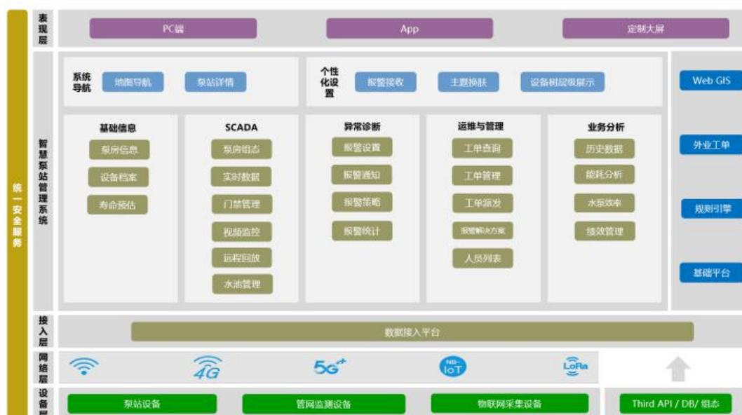
图 5.4 泵站管理应用架构
