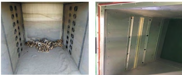
图4 不同厂家超声波探头布局图
